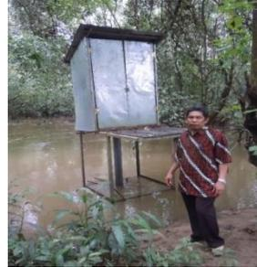
**Gambar 4.3.** Stasiun pengukuran debit air menggunakan pengukur TMA *automatic*
