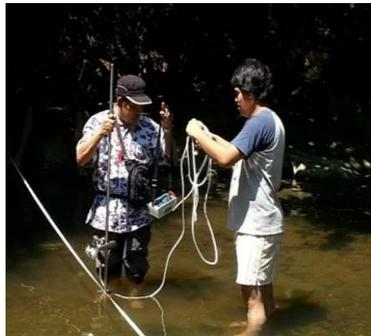
**Gambar 4.4.** Gambar 14. Stasiun pengukuran debit air menggunakan pengukur TMA manual dan menggunakan *current meter*
