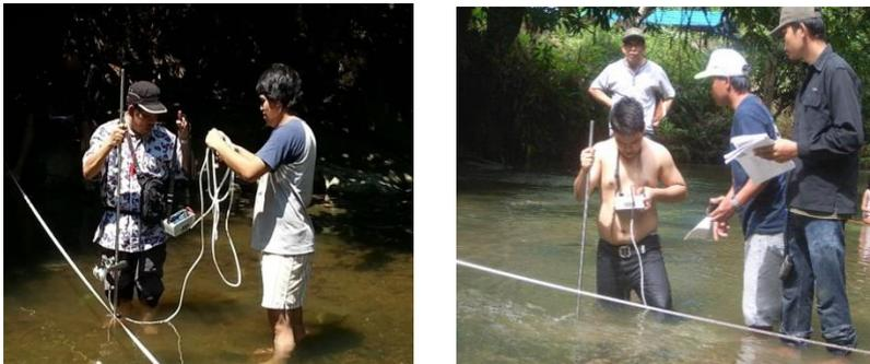
Gambar 5.22. Pengukuran debit air menggunakan *current meter*.
