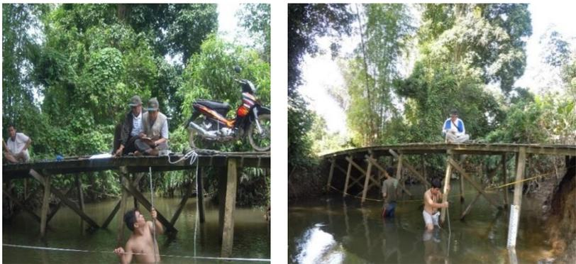
**Gambar 5.19.** Pengukuran debit air bagian tengah *catchment area* Jaing sub DAS Negara menggunakan *current meter* (stasiun pengukuran debit air)
