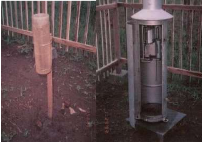
Gambar 3.4 Pengukur hujan manual.(kiri) Pengukur hujan otomatis (kanan)
