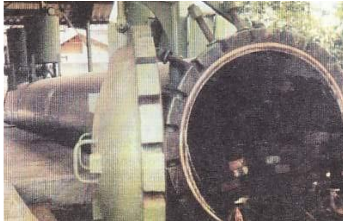
Gambar 27. Metode pengawetan kayu secara vakum tekan
